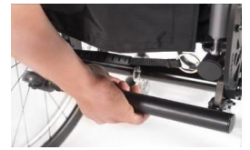
AGN090008 Podnoszone kółko antywywrotne, obsługiwane przez użytkownika
