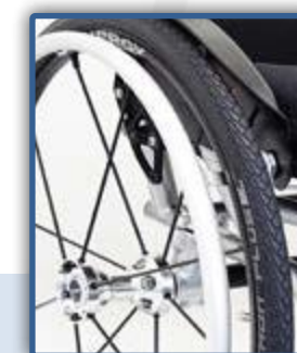
Koła Spinergy – najbardziej znane koła ze szprychami węglowymi, w zaplocie radialnym
