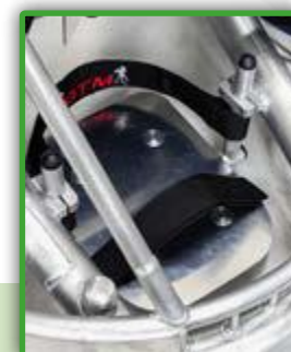
Platforma podnóżka z regulacją wysokości
