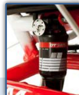
Amortyzator gazowo-olejowy zapewnia płynniejszą i bardziej komfortową jazdę
