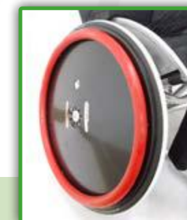
Koła z ciągami powlekаными gumą oraz z mocnymi osłonami na szprychy
