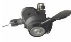
Przerzutka typu uniwersal, cynglowa
